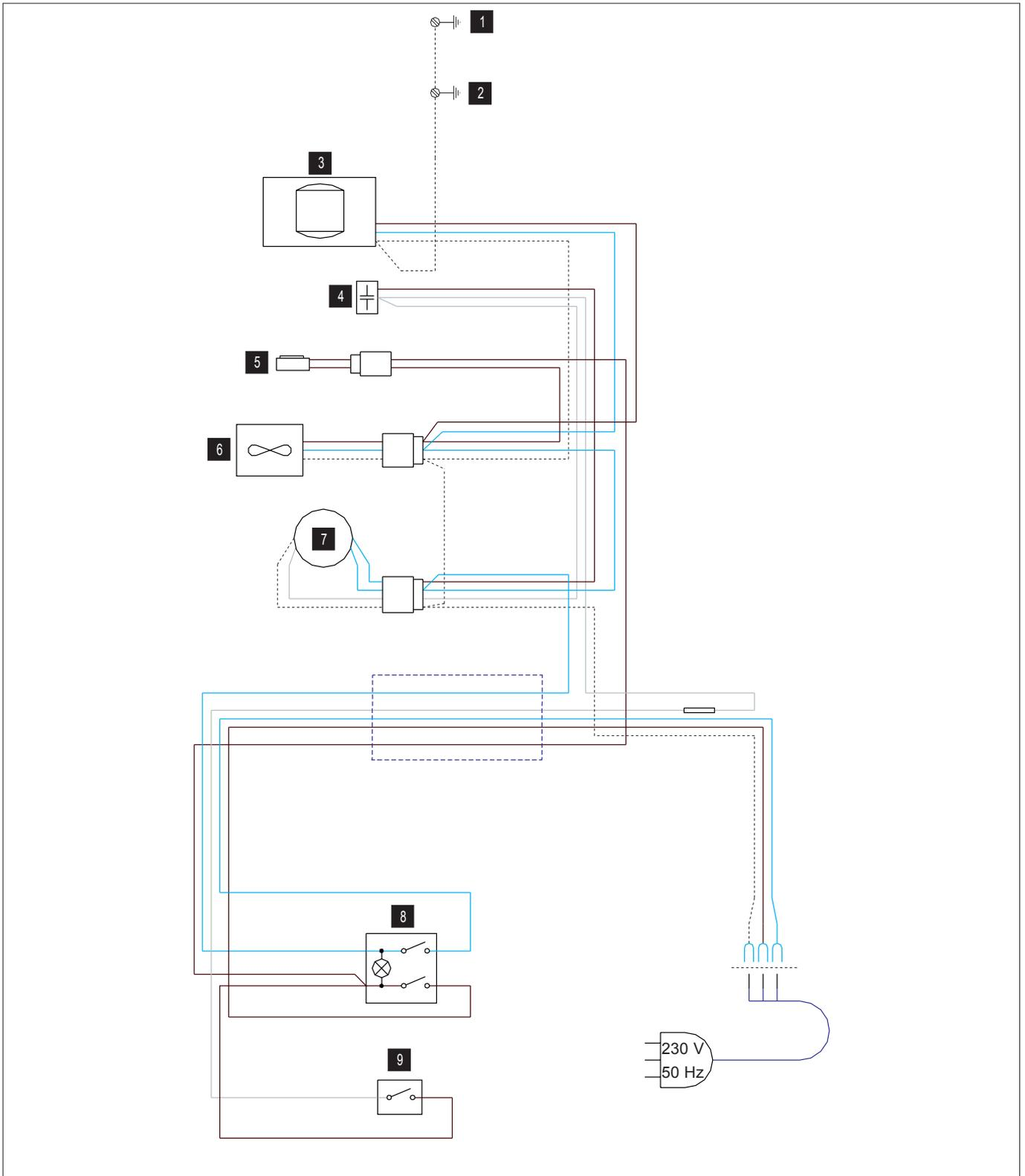
**1** Rückwand**4** Kondensator**7** Elektromotor**2** Innengehäuse**5** Thermostat**8** Hauptschalter**3** Kompressor**6** Ventilator**9** Mikroschalter
