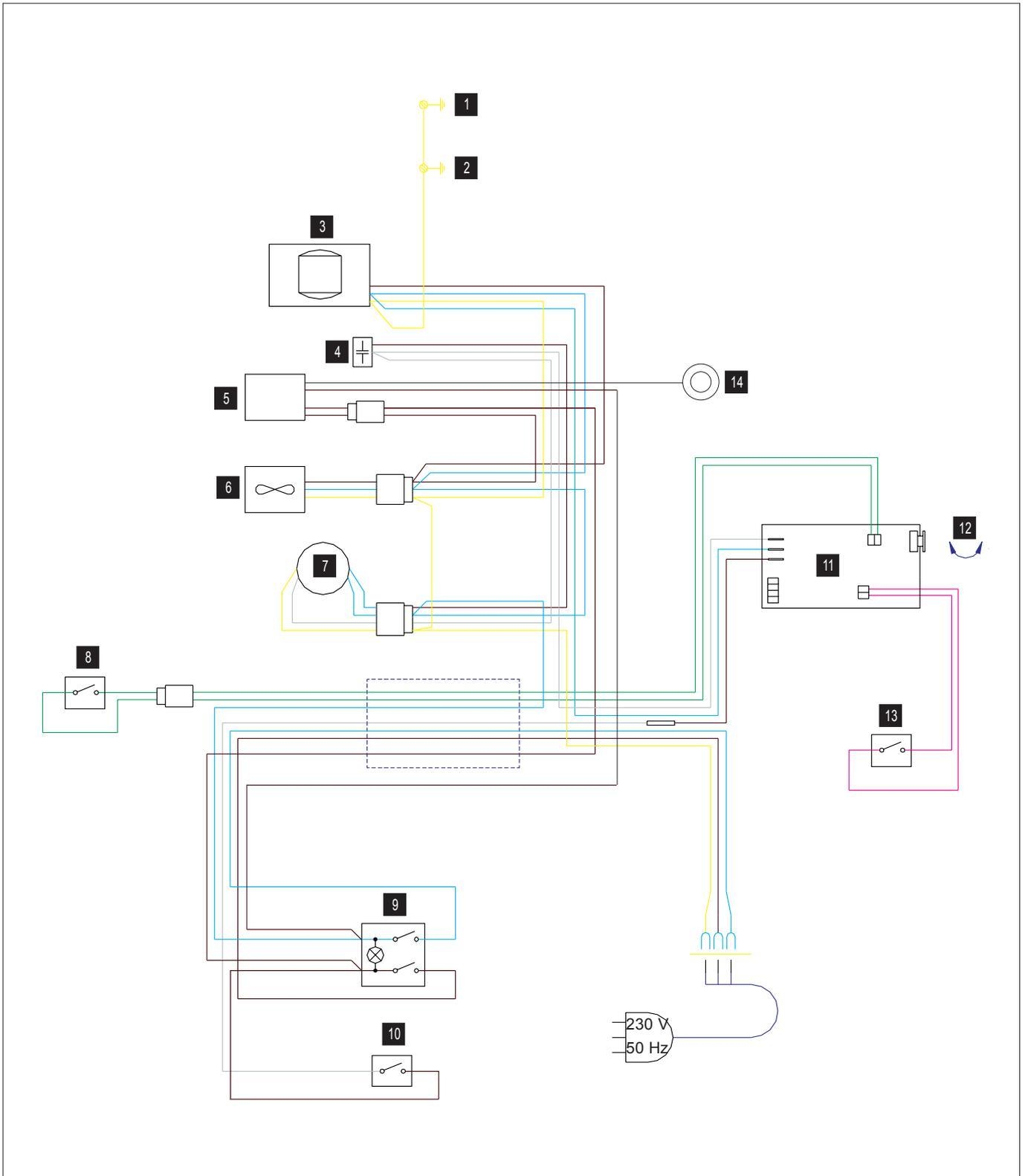
**1** Rückwand**6** Ventilator**11** Steuerprint**2** Innengehäuse**7** Elektromotor**12** Portionenschalter**3** Kompressor**8** Drucktaste für Reinigung**13** Dosierung**4** Kondensator**9** Hauptschalter**14** Temperatur-Fühler**5** Thermostat**10** Mikroschalter
